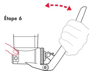
7. Veiller à ce que la sortie d'eau reste bien bouchée. Observer l'eau dans la gourde pendant 30 secondes : si un flux constant de bulles d'air s'échappe de la sortie d'eau propre, cela signifie que le purificateur **N'EST PAS SÛR** à utiliser. Si seulement quelques bulles sortent, actionner la poignée encore 5 fois et observer encore pendant 30 secondes. Si vous ne notez plus de bulles, la pompe peut être utilisée sans danger.
